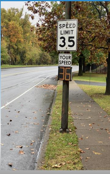
ENRADD (Electric Non Radar Device)
