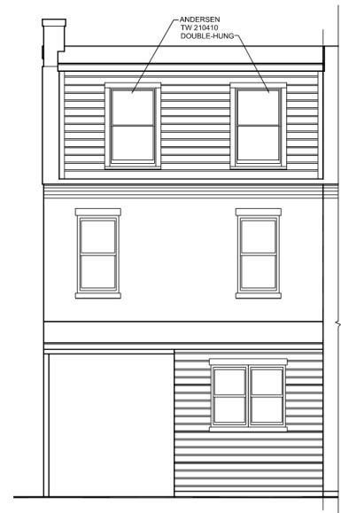
5 SOUTH ELEVATION A1 SCALE: 1/4" = 1' - 0"
